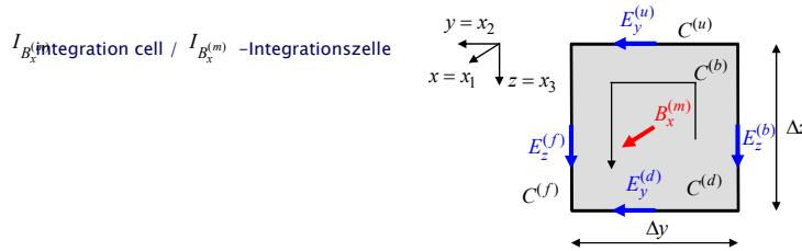
$$\oint_{C=\partial S} \underline{\mathbf{E}}(\underline{\mathbf{R}}, t) \cdot d\underline{\mathbf{R}} = E_y^{(u)}(t) \Delta y + E_z^{(f)}(t) \Delta z - E_y^{(d)}(t) \Delta y - E_z^{(b)}(t) \Delta z + O[(\Delta y)^3] + O[(\Delta z)^3]$$
