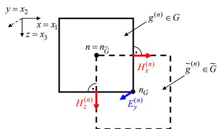
Two-dimensional staggered grid system in the 2-D TM case / Zweidimensionales versetztes Gittersystem im 2D-TM-Fall
